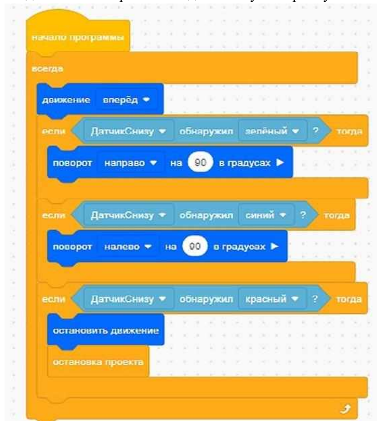
Рис. 32. Скрипт движения VR-робота по дисковому лабиринту
